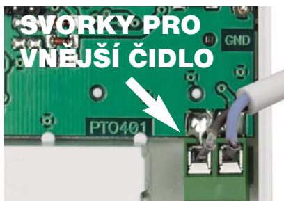
Obr.1 Připojení vnějšího čidla
