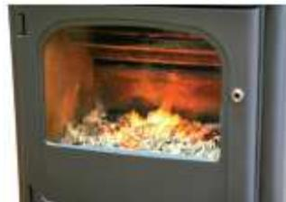
7. Zavřete dvírka, ale přívod sekundárního vzduchu nechte zcela otevřen. Přiložená polena vzplanou během několika málo minut. Po jejich rozhoření zcela zavřete přívod primárního vzduchu (levá páčka).
