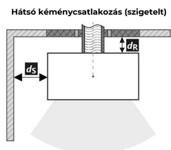
A füstcső áthaladása éghető anyagból készült falon
