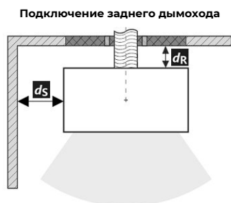
Проход дымовой трубы через стену из горючего материала
