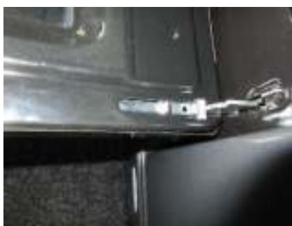
Obr. 20a Kovová západka pantu v poloze při běžném provozu
